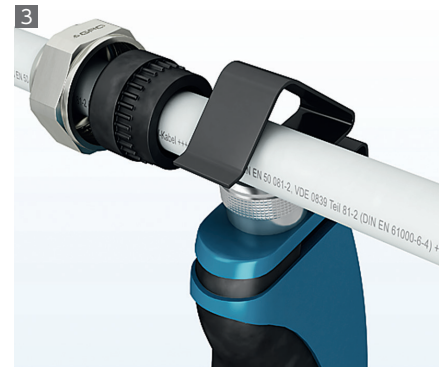
シールドケーブルの被覆を剥く。
